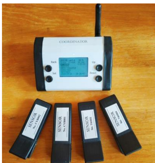
РИС. 8. Фрагмент мережі бездротових смарт сенсорів, підготовленої до серійного виробництва
